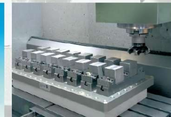
灵活使用夹紧元件缩短装配时间：在UPC栅格状托板上安装EROWA夹紧装置的虎钳。
