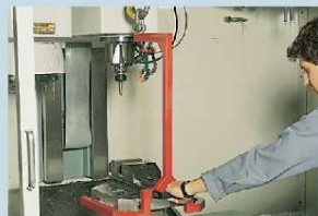
UPC的LiftGear吊运装置，通过高架吊车方便装载UPC卡盘。
