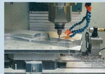
UPC也适用于大工件的加工：工件装在UPC托板上铣出轮廓。
